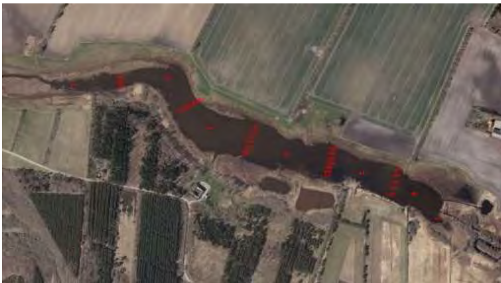
Figur 6.1: Punkter til kortlægning af sedimenttykkelser i Byn.
